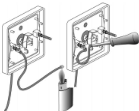
Einlegen der Zugschnur (nur bei Verwendung als Zugtaster)
