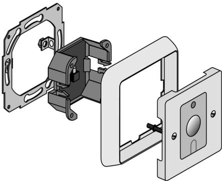
1. Tragring auf die Schalterdose montieren
