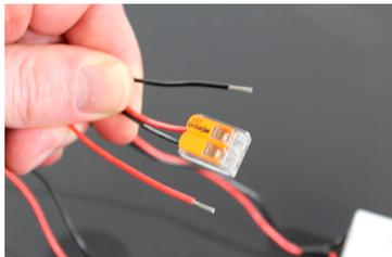
Führen Sie die schwarze Ader des ersten Akkus zusammen mit der roten Ader des zweiten Akkus in der beigefügten Klemme zusammen. Die Akkus werden in Reihe geschaltet.
