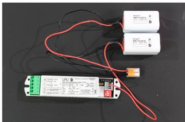
Die verbleibenden Adern schließen Sie wie bisher an der Akku-Akku-Anschlussklemme des LPU-Moduls an.
