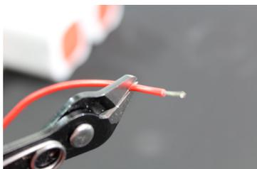
**Schneiden Sie unbedingt vor der Rücksendung des alten Akkus die offenen Adern ab, da beim Transport sonst akute Kurzschluss- und Brandgefahr besteht!**
