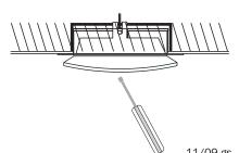
Das Gehäuse mit dem Rahmen in die Zwischendecke/
