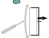
3. Die Metallklammer vom Gehäuse lösen.
