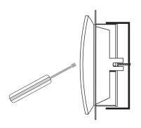
6. Die Metallklammer mit der Schraube in der Mitte des Kunststoffgehäuses wieder locker anschrauben.
