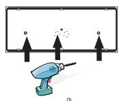
2. Die 2 Befestigungslöcher und eine Sollbruchstelle für die Kabeldurchführung aufbohren.
