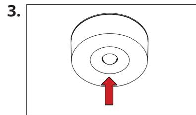
Bitte beachten Sie bei der Montage die durch den Pfeil im Gehäuse angegebene Abstrahlrichtung für ILxF oder ILxH.
