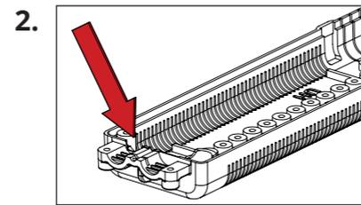
Öffnen Sie das Elektronikgehäuse. Zum Installieren der Zugentlastung die Trennwand entfernen. Achten Sie darauf scharfe Kanten zu vermeiden.
