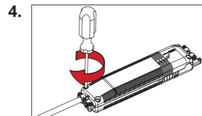
Schließen Sie das Elektronikgehäuse und verschrauben die Zugentlastung.
