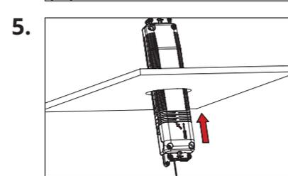
Legen Sie das Elektronikgehäuse in die Zwischendecke. **Lochausschnitt ø 68-76mm.**
