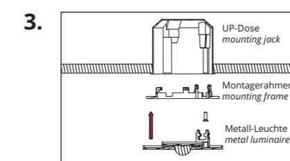
Entfernen Sie die Haltefedern an der EE-Leuchte. (Zubehör erf. Montagerahmen Art.-Nr. EE-EBA)
