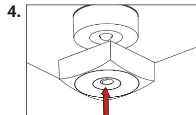
Akku anschließen (nur bei Einzelbatterieleuchten). Deckel auf das montierte Leuchtenunterteil drücken.
