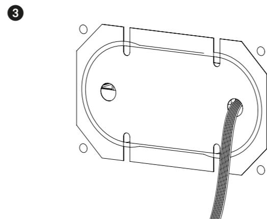
Transparente Isolierfolie ansetzen und 7-pol. Kabel durch ein Loch fädeln.
