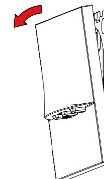
WEF-Metall-Lampe nach oben drücken und aushebeln. Ggf. mit einer Spachtel oder Schraubenzieher nachhelfen.
