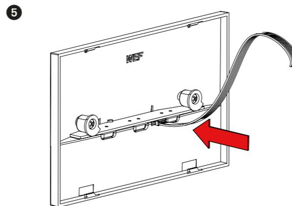
7-pol. Kabel an die Platine anschließen.
