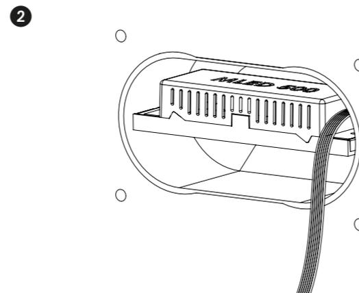
Elektronik anschließen und einsetzen. Ggf. die Laschen abwicken. Bei Einzelbatterieleuchten den Akku unter der Elektronik platzieren.
