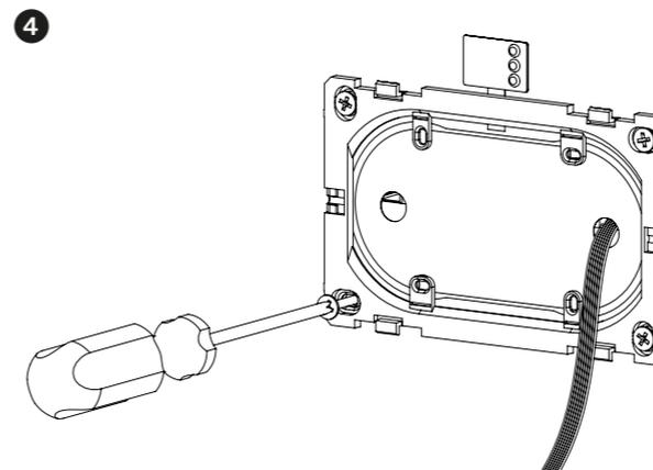
Universalrahmen darüber platzieren und verschrauben. Den Prüftaster optional unter dem Universalrahmen nach Außen führen.
