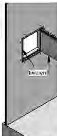
Die Klappe der LEG-R 30/60 vorsichtig öffnen, gleichzeitig den Rahmen mit den Händen fixieren. Die Putzkante von 2 mm an Rahmen und Tür ragt über die Schachtwand hinaus.
