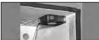
3. Verschrauben Sie den Lüfter mit dem Verteilergehäuse. (Befestigungsmaterial liegt bei)
