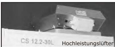
6. Stellen Sie nun die Spannungsversorgung des Lüfters her, indem Sie das Stromkabel durch die Kabeleinführung (CKE) in den Verteiler führen und dort anschließen.
