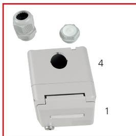
Deckel (1) von dem IP44 Gehäuse aufschrauben und abnehmen. Bei UP-Gehäuse (HSEIP44UPT) den Tragring (2) auf die Geräteeinbaudose (3) (HSEIP44UDT) aufschrauben, bei AP-Gehäuse (HSEIP44APT) den AP-Rahmen (4) an der Wand montieren, die Verlegekabel in die Geräteeinbaudose (3) oder in das AP-Gehäuse (4) einführen.
