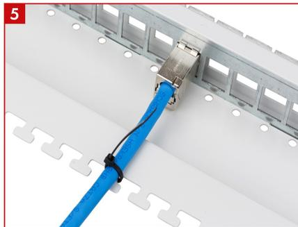
Kabel mit Hilfe beiliegender Kabelbinder am Kabelabfang befestigen. Darauf achten, dass das Kabel hierbei nicht zu stark verformt wird.
