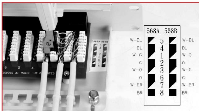
Legen Sie die Drähte entsprechend dem Farbcode 568A/568B in den entsprechenden Anschluss der IDC Anschlussleiste ein. Kontaktieren Sie die Drähte mit dem Anschlusswerkzeug (Best.Nr.: HKRONELSA). Die Verdrillung ist bis zum Kontaktblock beizubehalten. Den Twist nicht öffnen.
