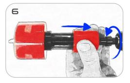
Diese Aufnahme ist für Lochsägen von Durchmesser 38 bis 127 mm geeignet. Bitte beachten Sie die Drehzahl-Tabelle!
