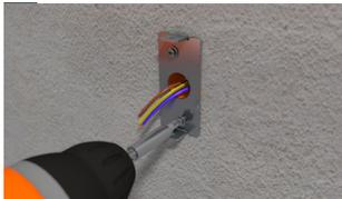
Lampenhalterung ohne Dübel durch den Putz verschrauben.
