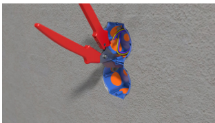
Verbindung mit Dosencutter ausschneiden oder einfach ausbrechen.
