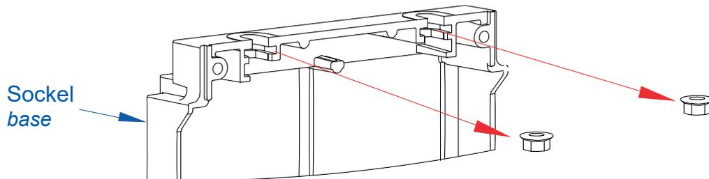
**Schritt 2** Teile des Beipackes laut unterer Abbildung montieren
