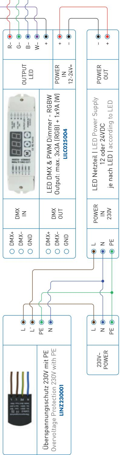
Überspannungsschutz 230V mit PE
